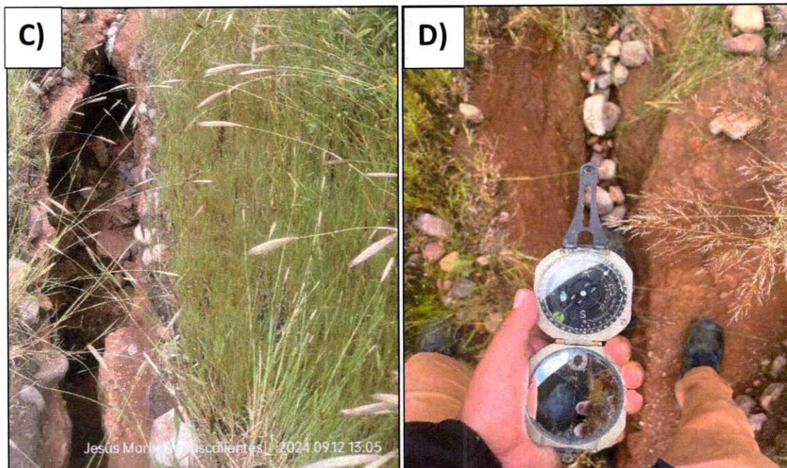
Ilustración 3. Evidencia fotográfica de la litología observada en campo. A) Material limo arcilloso color marrón. B) Depósitos vulcanosedimentarios. C) Conglomerado polimíctico con matriz de arenas limosas. D) Dato estructural de la Falla P. Esparza medido en campo.
