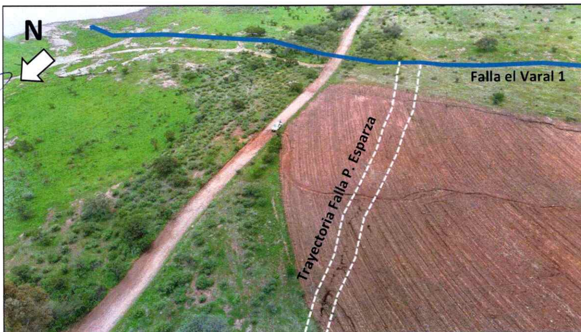
Ilustración 6. Imagen obtenida con el dron, donde se observa la trayectoria y los agrietamientos a nivel de terreno de la Falla P. Esparza, así como la Falla el Varal 1 representada en color azul marino.
