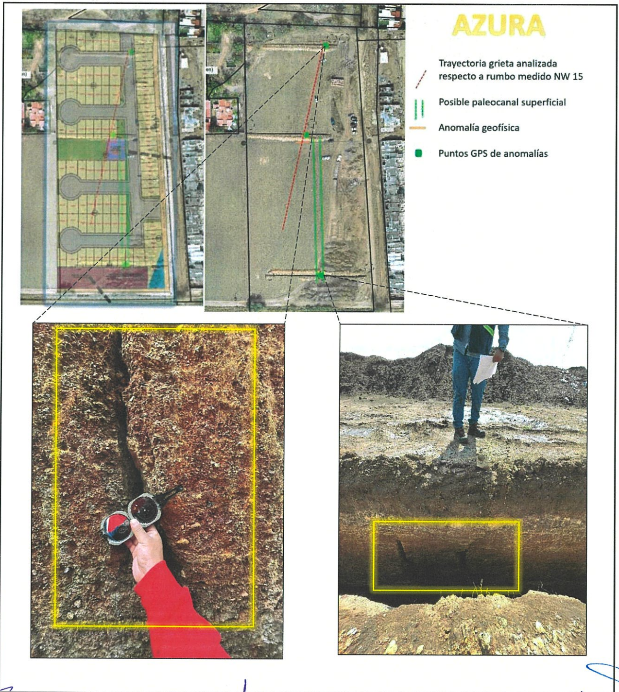
Figura 2. Lotificación del desarrollo Azura y traza de la discontinuidad observada en campo.
