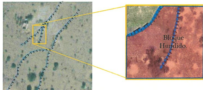
Figura 6 Traza de definitiva de la Falla Las Puntas con la indicación del bloque hundido en transparencia roja.
