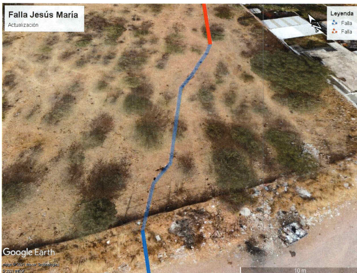
Figura. 3 Imagen obtenida mediante vuelo de dron, Mosaico georreferenciado con traza digitalizada.
